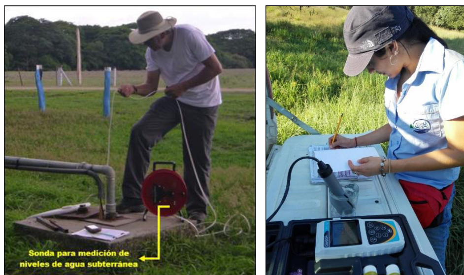
Fotografía 2. Medición de profundidad de niveles de agua en pozos y monitoreo de parámetros físico-químicos de las aguas de pozos de la red de monitoreo de la zona de Colorado de Abangares y alrededores.
