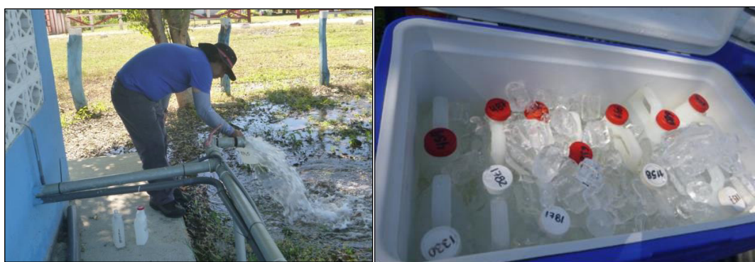
Fotografía 3. Muestreo físico-químico en conjunto con el LNA del AyA. Se utilizan envases diferenciados con tapa roja que son los que contienen ácido para la conservación de las muestras de agua para el análisis de metales pesados.
