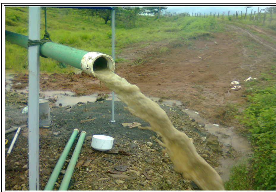
Figura 5: Características físicas del agua extraída durante la prueba de bombeo.
